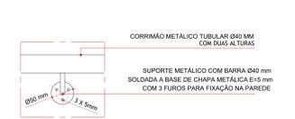
ELEVÇÃO - DETALHE GÊNÉRICO DA FIXAÇÃO DO CORRIMÃO NA PAREDE
