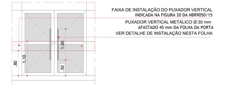
**FAIXA DE INSTALAÇÃO DO PUXADOR VERTICAL INDICADA NA FIGURA 20 DA NBR9050/15**
