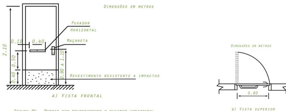
FIGURA 84 - PORTAS COM REVESTIMENTO E PUXADOR HORIZONTAL
